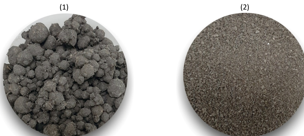
Rysunek 13. (1) - osad po suszeniu, (2) – rozdrobnienie
