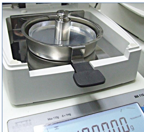
Zdjęcie nr 2. Adiustacja wagosuszarki MA 110.R (wzorzec o masie 100 g)
