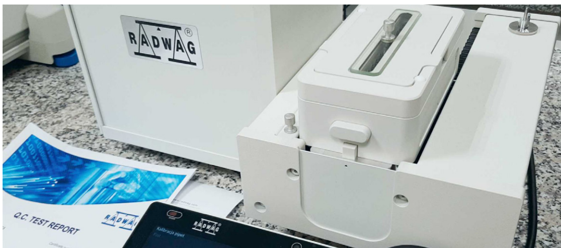
Rys. 18. Automat AP 12.5Y podczas kontroli metrologicznej
