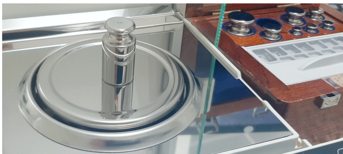
Rys. 4. Kontrola stabilności wagi wzorcem masy
