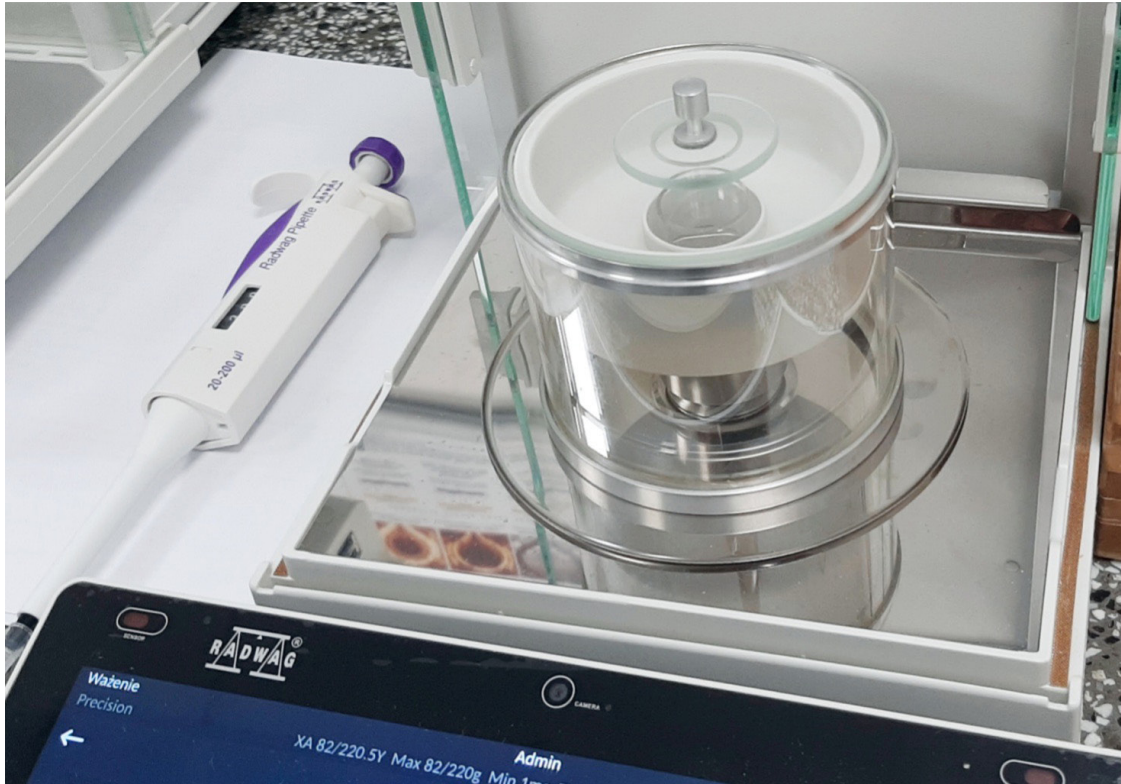
Rys. 12. Waga XA 82/220.5Y z naczyniem wagowym o pojemności 17 ml
