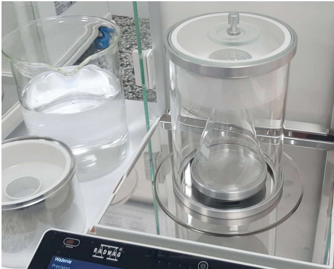
Rys. 15. XA 82/220.5Y z naczyniem wagowym o pojemności 100 ml
