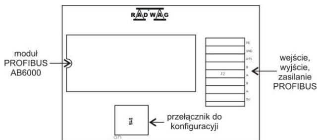
Usytuowanie modułu PROFIBUS na płycie 385R ver.A
