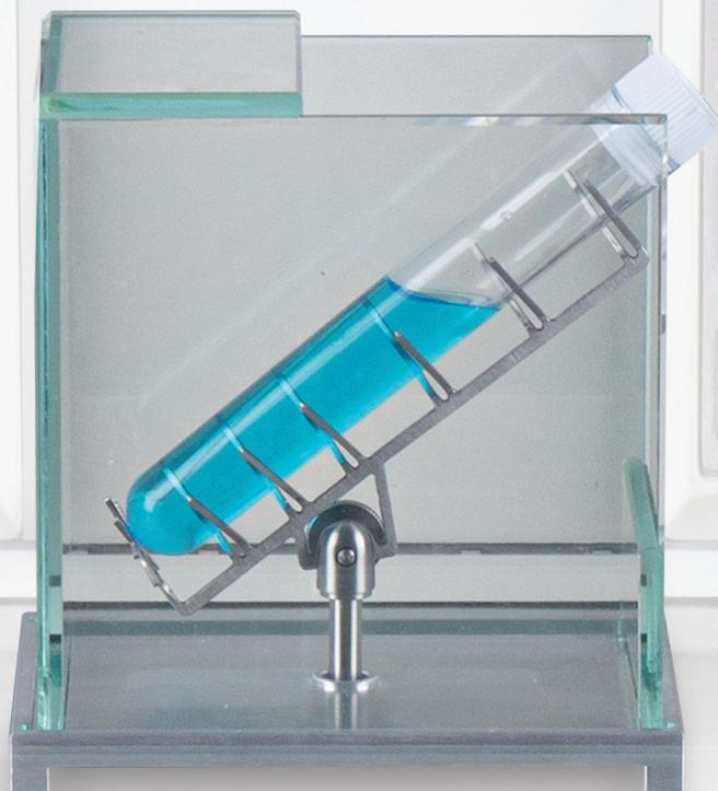
Les poignées ont la possibilité d'incliner la micro-vaisselle, ce qui permet de la régler dans n'importe quel angle, en fonction de l'application. Le kit comprend une cage en verre qui protège le support de la micro-vaisselle qui stabilise les conditions de mesures dans la chambre de pesage et un organisateur pour ranger les poignées.
