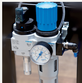
Station de préparation d'air
