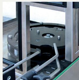
Distributeur rotatif pour les produits cylindriques
