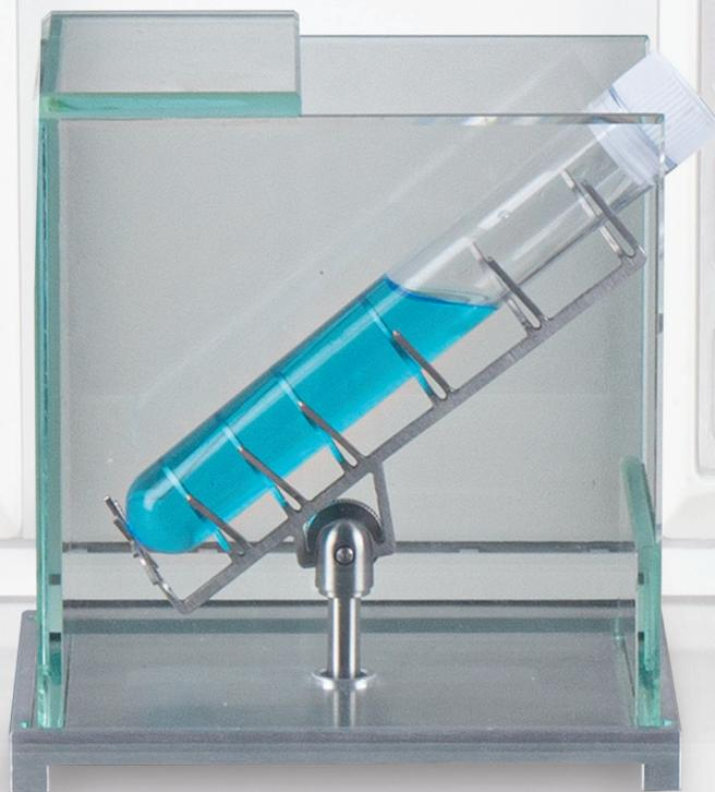
Los soportes tienen la posibilidad de inclinar el microtubo, lo que permite colocarlo en cualquier ángulo, dependiendo de la aplicación. El juego incluye corta aires especiales, que estabilizan las condiciones de medición en la cámara de pesaje.
