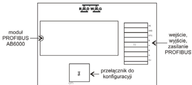
Ubicación del módulo PROFIBUS en el tablero 385R versión. A
