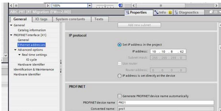
Podemos ir a la configuración del módulo. Al principio, definimos el tamaño de los registros de entrada y salida y definimos sus direcciones de inicio. Para ello, de la lista de módulos de ENTRADA y SALIDA disponibles, seleccione los que se muestran en la siguiente imagen. El tamaño máximo de los datos de entrada es 116 bytes y los datos de salida son bytes. El proyecto utiliza las direcciones de inicio predeterminadas: 68 para el módulo ENTRADA y 64 para SALIDA:
