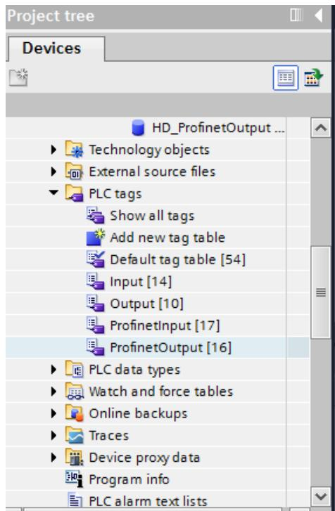
Las tablas ENTRADA y SALIDA se refieren a las entradas / salidas físicas del controlador MASTER y no tienen ningún significado en esta aplicación. Los registros de entrada y salida del módulo PROFINET se definen en las tablas ProfinetInput y ProfinetOutput. Las figuras siguientes muestran los nombres y direcciones simbólicos asignados:
