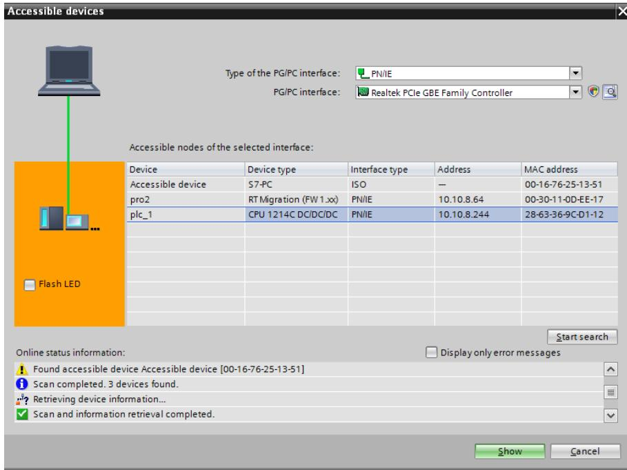
A continuación, debe definir la dirección IP del módulo y su nombre en la red PROFINET. Despué s de seleccionar el módulo en la pestaña PROPIEDADES, busque el submenú PROFINET INTERFACE donde ingrese la dirección IP y dé un nombre. Estos ajustes deben ser compatibles con los parámetros establecidos en el menú de la balanza. Recuerde que la dirección IP SLAVE debe estar en la misma subred que la dirección MASTER.
