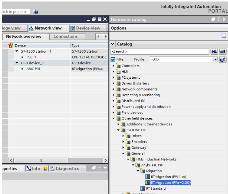
Ya puede crear una red que consta de un controlador MASTER y un módulo SLAVE agregado:
