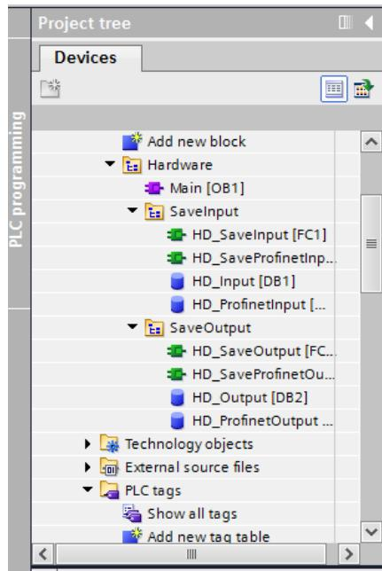
Los bloques HD\_OUTPUT y HD\_INPUT se refieren a entradas / salidas MASTER físicas y no son relevantes en términos de este proyecto. Los bloques HD\_ProfinetOutput y HD\_ProfinetInput se refieren a los registros de entrada / salida del módulo PROFINET en un instrumento de pesaje. Tienen el siguiente aspecto:
