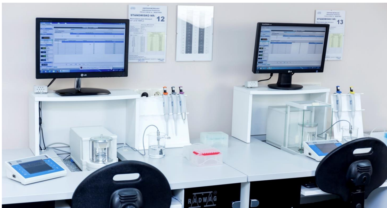
Imagen 16. Puestos de control de pipetas de pistón de varios volúmenes
