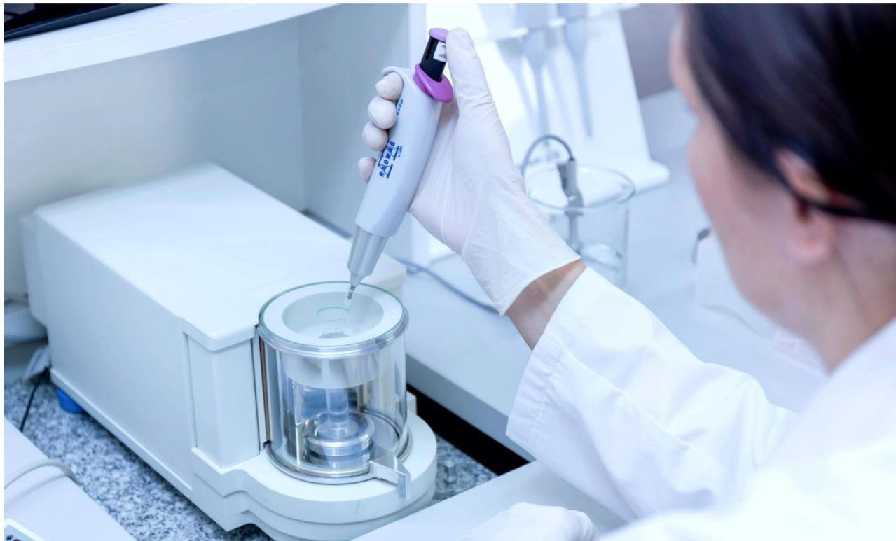
Imagen 9. Control de volumen de pipetas de pistón utilizando una microbalanza serie MYA
