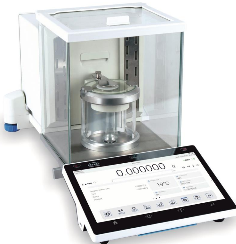
Imagen 8. Balanza XA: un sistema manual para controlar el volumen de las pipetas de pistón
