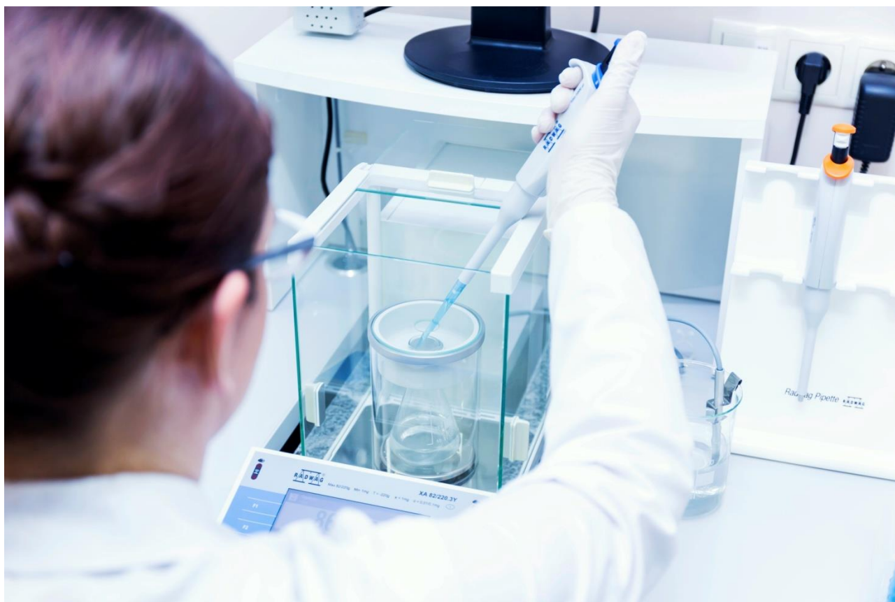
Imagen 6. Inspección de una pipeta de pistón de 200 µl
