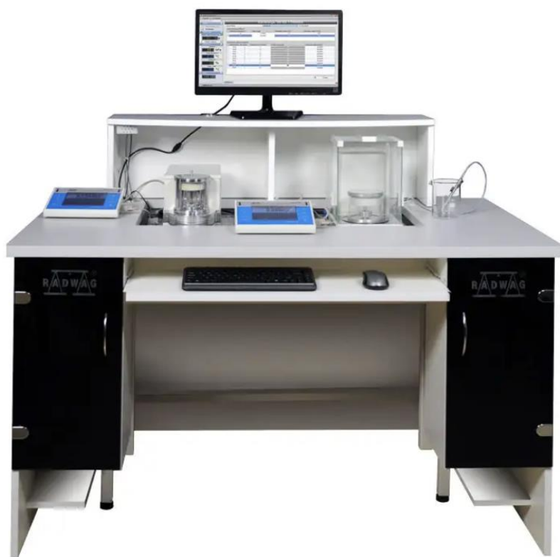
Imagen 11. Mesa de control y calibración de pipetas de pistón.
