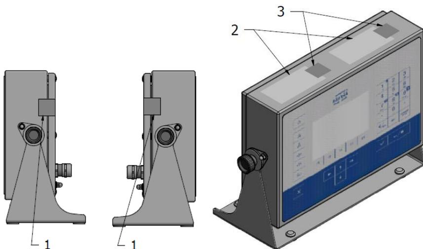
*Disposición de placas de datos y pegatinas de seguridad.*
