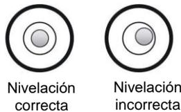
En balanzas multisensores, el rango de ajuste de nivel es limitado. Se proporciona el nivel correcto colocando placas / arandelas de acero debajo de las patas de la balanza.
