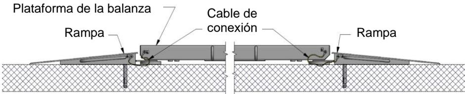
Resistencia permitida entre partes metálicas particulares  $<100\Omega$
