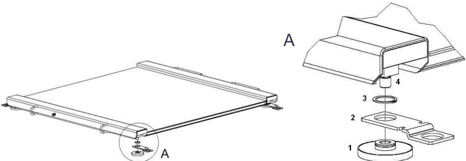
Coloque la balanza sobre una superficie plana. Coloque rampas sobre abrazaderas de acero. Retire las rampas y marque los lugares donde se perforarán los orificios para los anclajes a través de los orificios en las abrazaderas.
