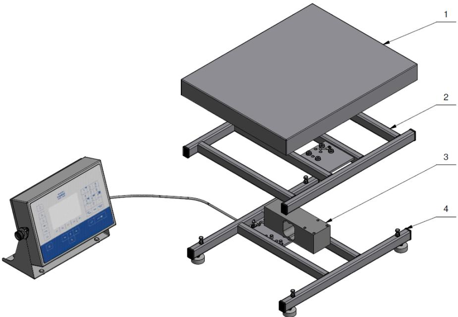
*Vista de los componentes principales de la construcción de balanzas de un solo sensor*
