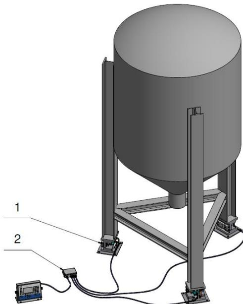
*Vista de los componentes principales de la construcción de balanzas con módulos extensométricos: 1 – módulo, 2 - sumador*
