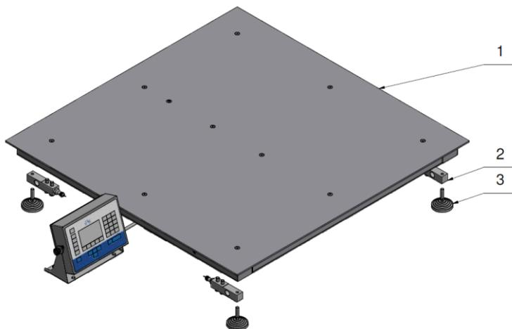
*Vista de los componentes principales de la construcción de balanzas multisensor*
