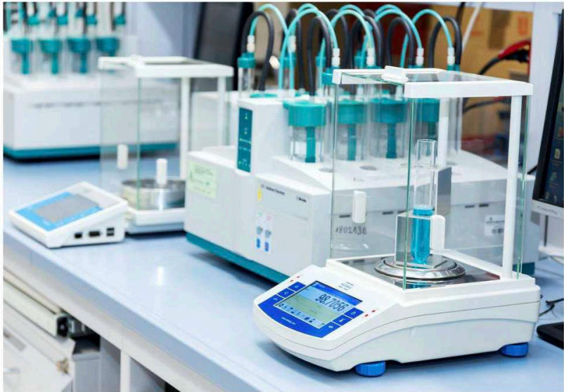
Abbildung 9. Waage AS 220.X2 – Messung der Flüssigkeitsmasse
