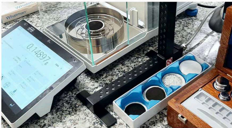
Abbildung 15. Statische Elektrizität bei der Filtermassenmessung – DJ-04 Ionisator
