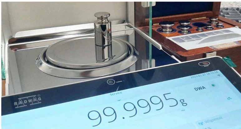
Abbildung 28. Zentritätstest der XA 220.5Y-Waage
