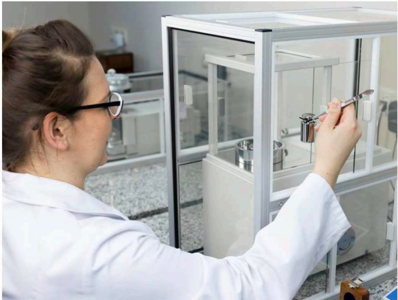
Abbildung 21. Komparator der WAX-Serie – Bestimmung der Masse des Gewichts
