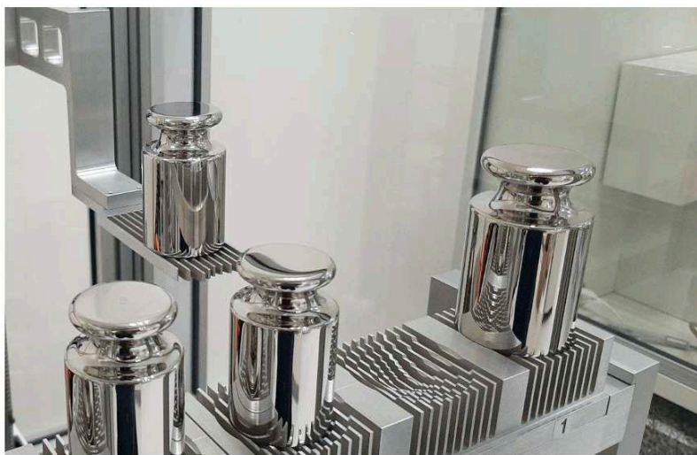
Abbildung 44. Massenstandards im automatischen Zyklus prüfen
