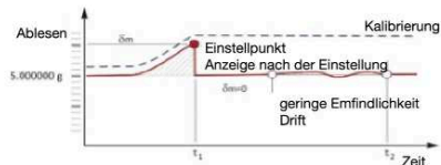
Abbildung 19. Unterschied zwischen Justierung (Kalibrierung) und Kalibrierung
