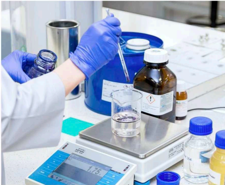
Abbildung 32. Dosierung von Inhaltsstoffen bei der Lackherstellung
