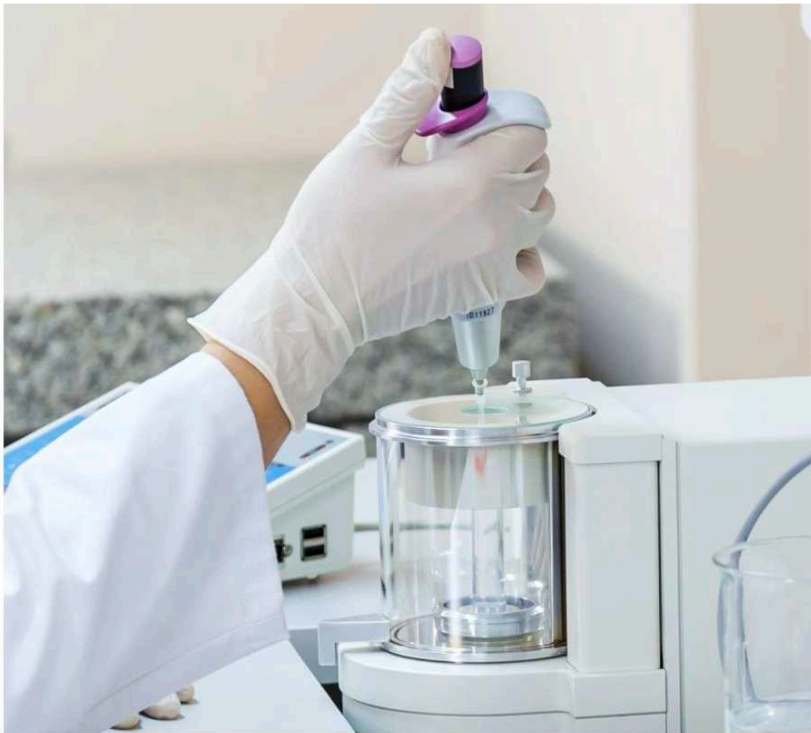
Abbildung 34. Kontrolle des Volumens von Kolbenhubpipetten
