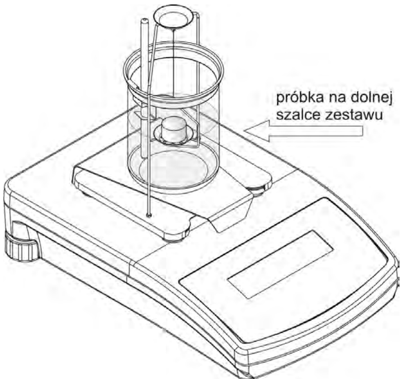
Abb. 28. Aufstellung der Probe auf untere Waagschale des Sets.
