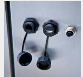
Kommunikationsschnittstellen (Ethernet, USB, RS-232)
