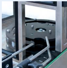
Rotationsförderer für zylindrische Produkte
