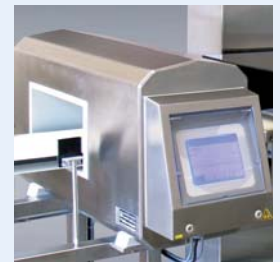
Detektor für Metalle und metallischen Verbindungen
