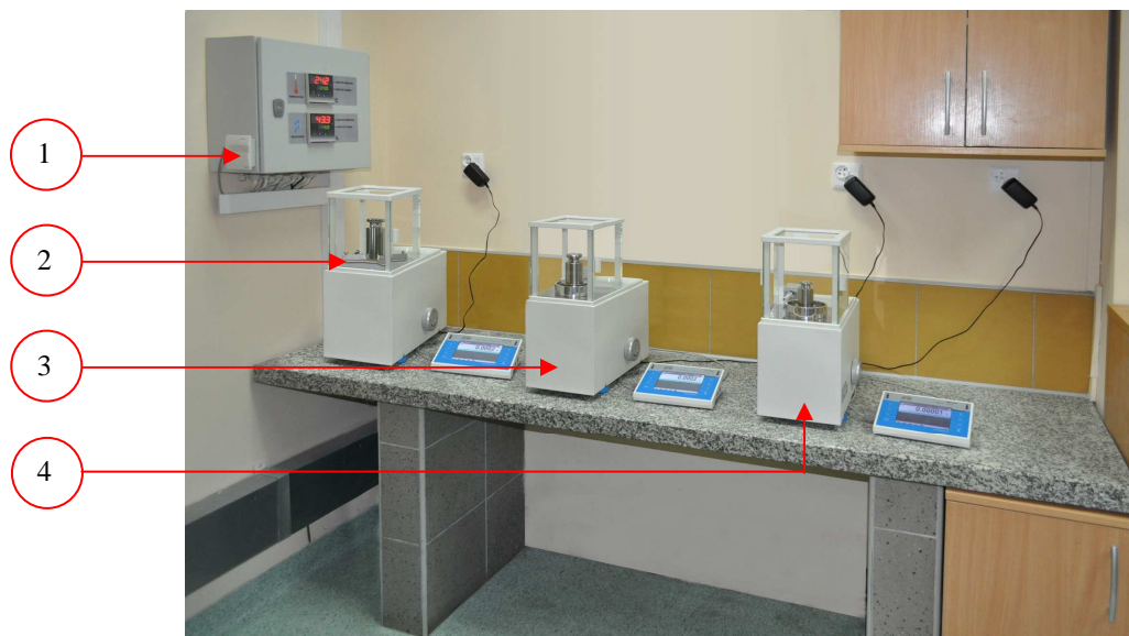
Rys. 5 Stanowisko pomiarowe przy badaniu manualnym komparatorów
