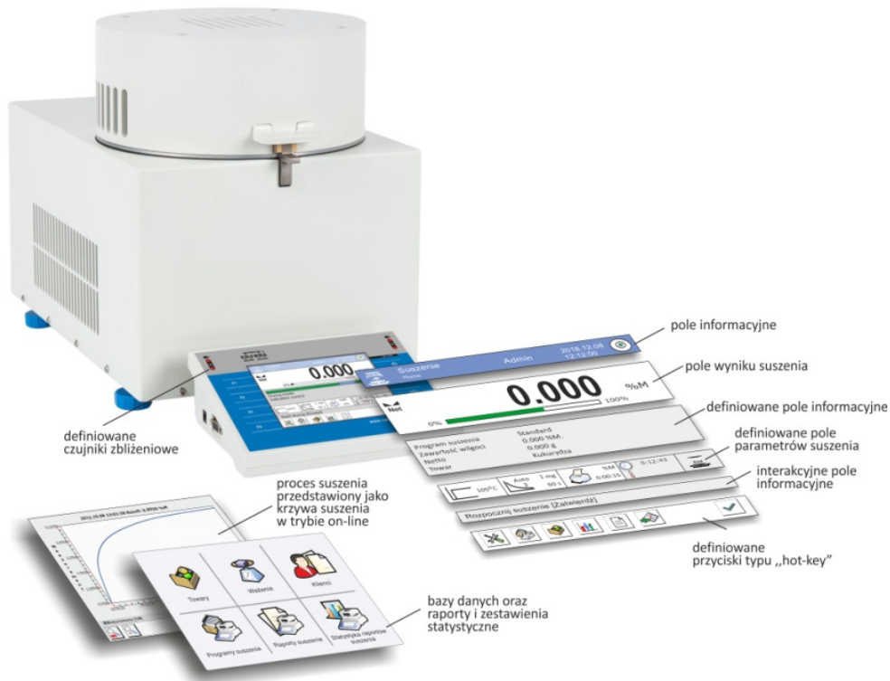
Rysunek 1. Wagosuszarka mikrofalowa PMV 50
