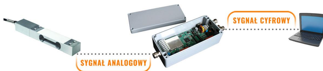
Rys. 29 Schemat połączeń tensometrycznego modułu wagowego MW-01.
