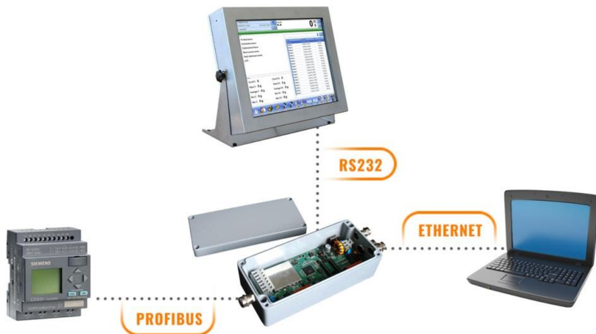
Rys. 31 Interfejsy komunikacyjne modułu wagowego MW-01.
