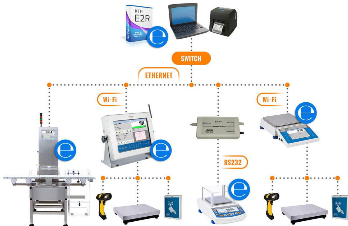
Rys. 70 Schemat systemu sieciowego KTP.
