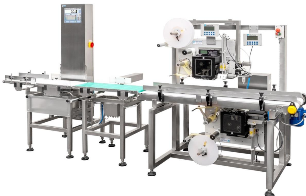
Rys. 88 System etykietujący góra - dół.
