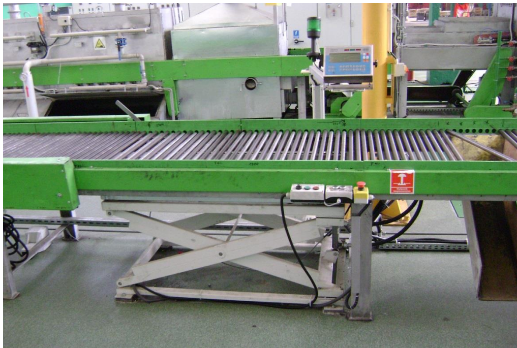
Rys. 75 Zastosowanie wagi nieautomatycznej w ciągu transportowym.
