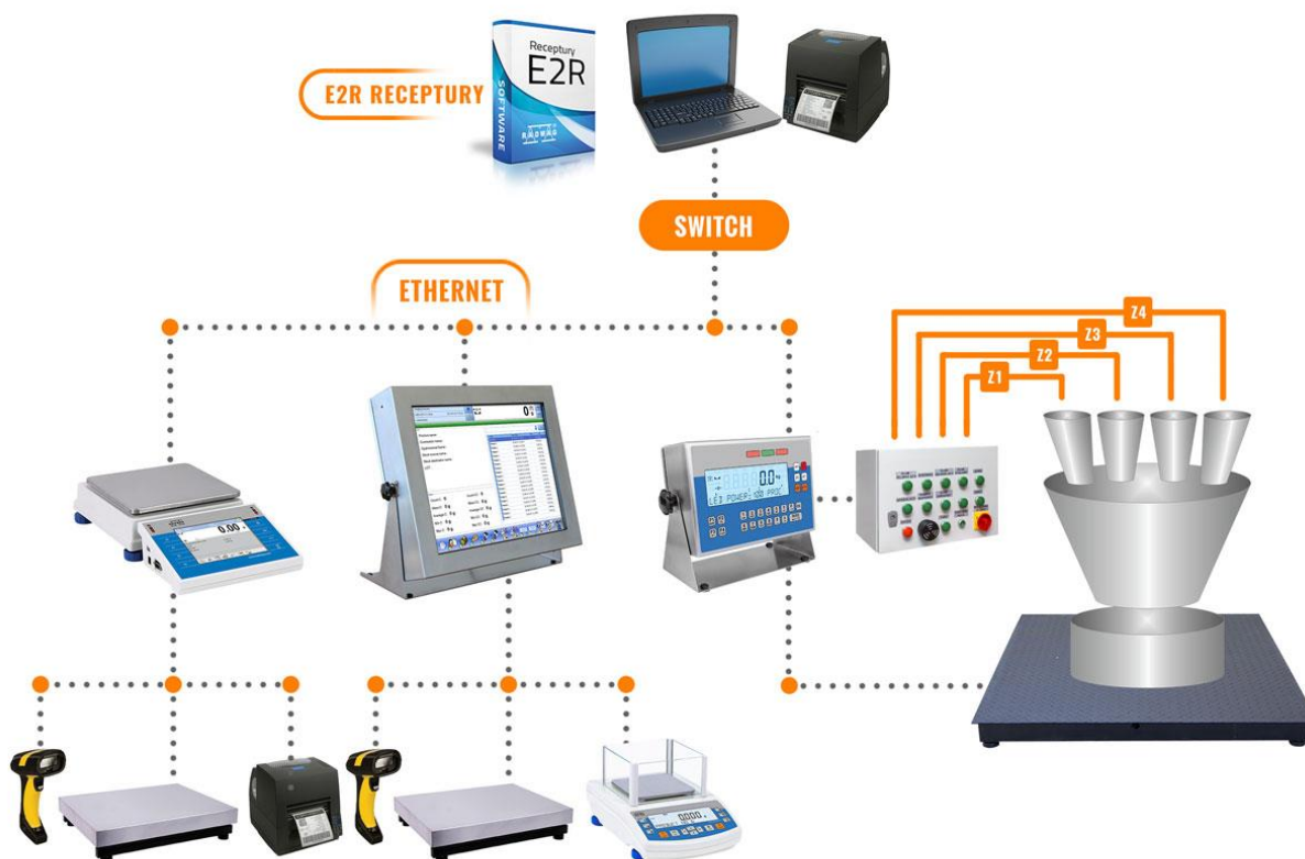
Rys. 69 Schemat układu recepturowania.
