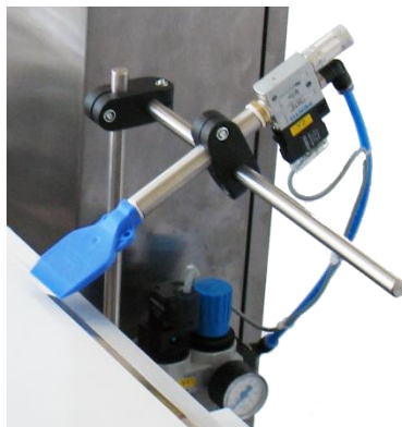
Rys. 91 Układ odrzutu sprężonym powietrzem.
