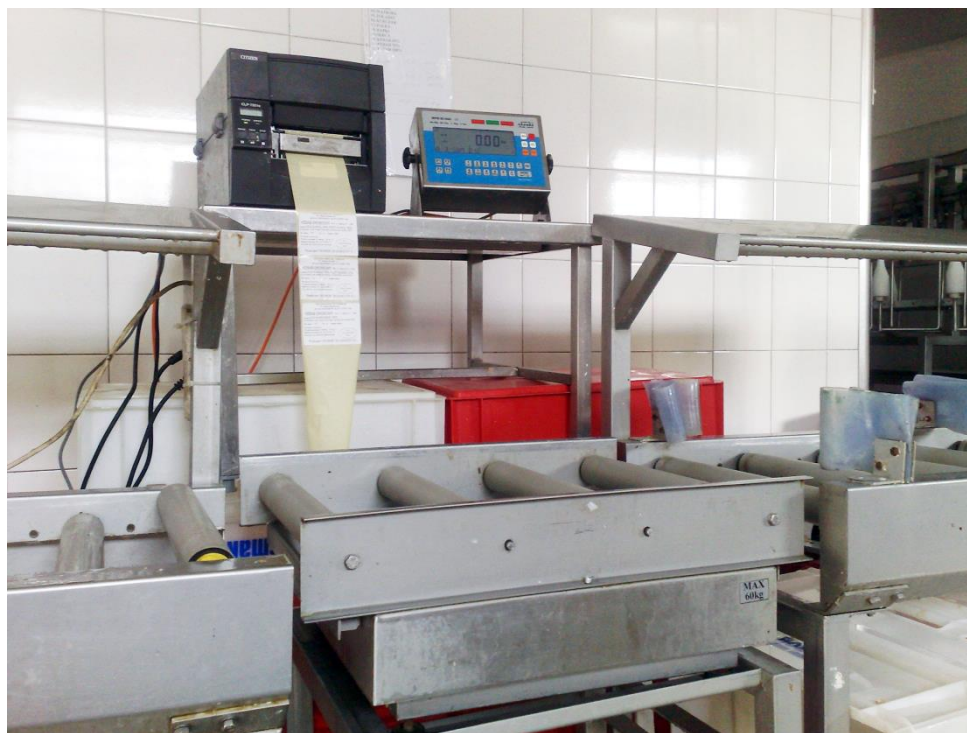
Rys. 66 Zestaw etykietujący na linii rozbiorowej.
