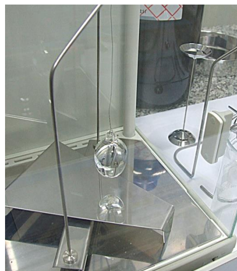
Pomiar gęstości cieczy (ważenie nurnika w powietrzu).
