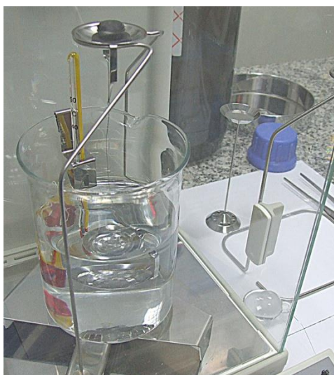
Pomiar gęstości ciała stałego (ważenie ciała stałego w powietrzu).
