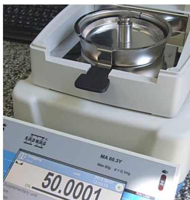
Dokładność wagosuszarki po wykonaniu adiustacji wzorcem zewnętrznym.
