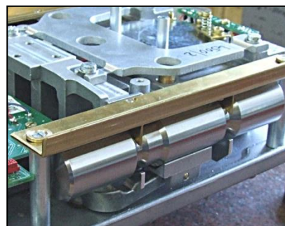
Wzorec masy wag serii PS zainstalowany w konstrukcji wagi (produkowanych do 2015r.)
