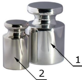
Zestaw wzorców do wyznaczania gęstości powietrza: (1) – wzorzec aluminiowy, (2) – wzorzec stalowy.
