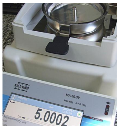
Błąd pomiaru masy w początkowym zakresie ważenia (wzorec o masie jak dla typowych próbek).
