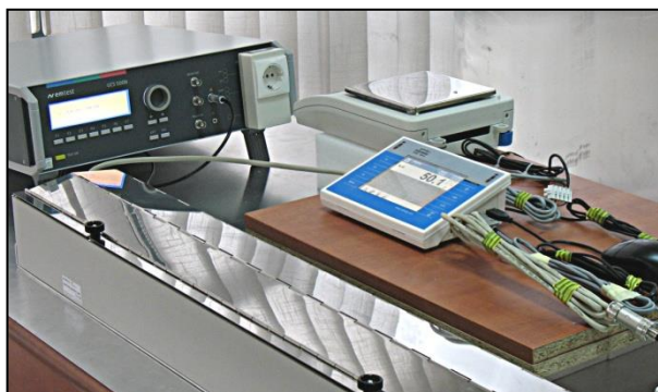
Badanie odporności wagi na zakłócenia.
