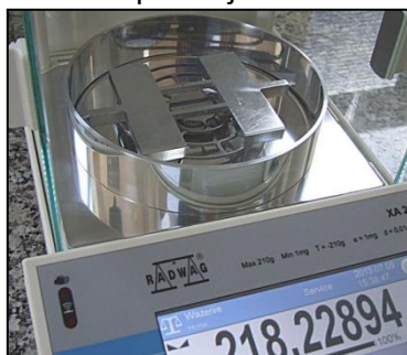
Określanie masy wzorca wag AS (produkowanych do 2015r.)
