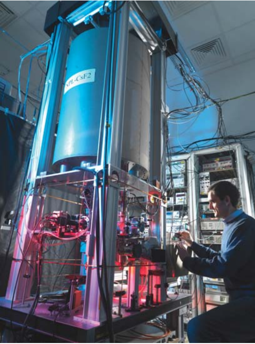
Pierwotny wzorzec częstotliwości – fontanna cezowa NPL-CsF2 (Fot. NPL)
