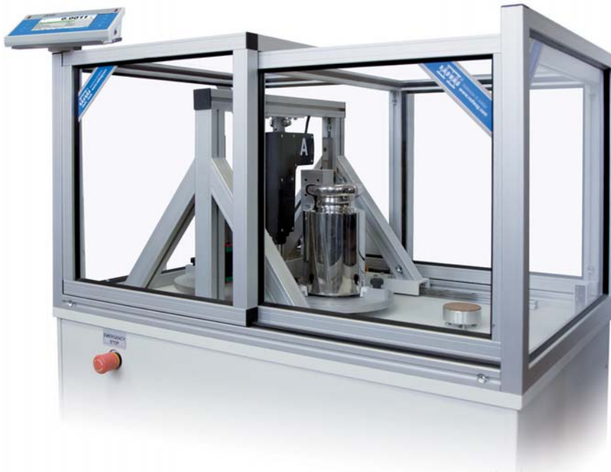
Komparator masy AKM4 (Fot. RADWAG)
