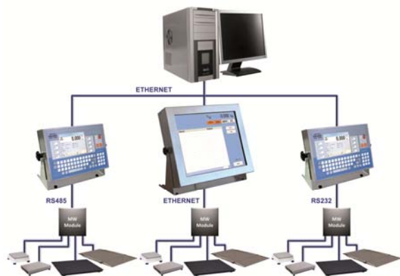
Rys. 8. System E2R Receptury – sieć Ethernet
