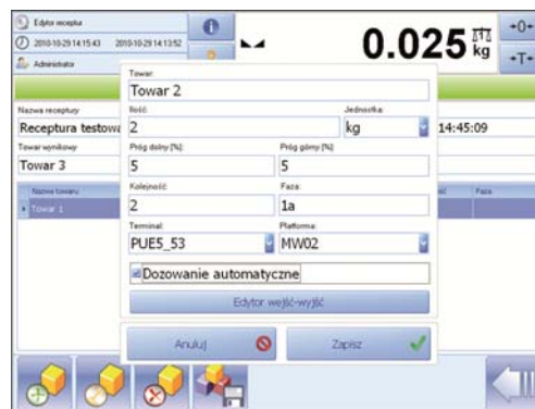
Rys. 6. Mod „Edytor receptur” miernika wagowego PUE 5
