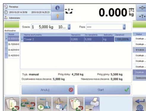
Rys.7. Zlecenie produkcyjne w modzie pracy „Receptury” miernika PUE 5
