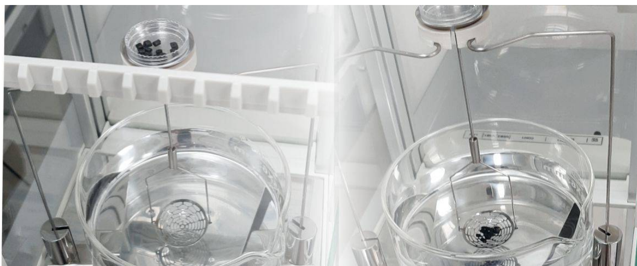
Rysunek 4. Badanie granulatu PA 6 GF 15 w wodzie destylowanej Pomiar masy próbki w powietrzu oraz w cieczy na dolnej szalce zestawu
