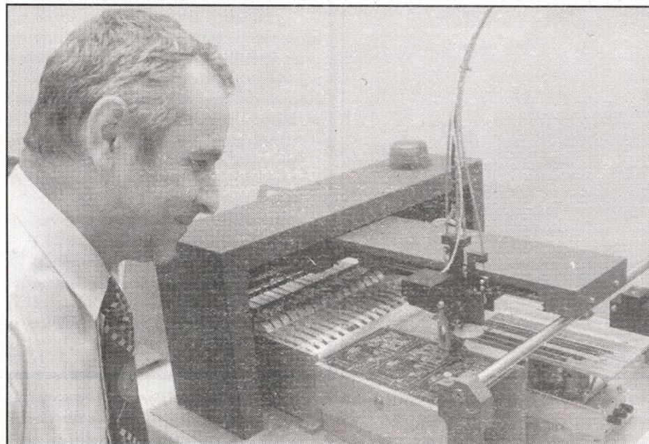
Automat błyskawicznie i precyzyjnie montuje elementy.
