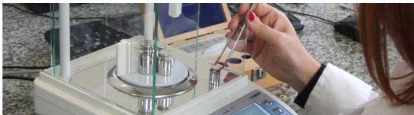
Figura 11. Control de sensibilidad de la balanza con patrones de masa: QC Radwag.
