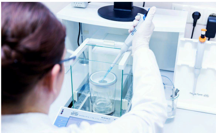
Figura 13. Control de volumen de pipetas de pistón: evaluación del sesgo y el error aleatorio.
