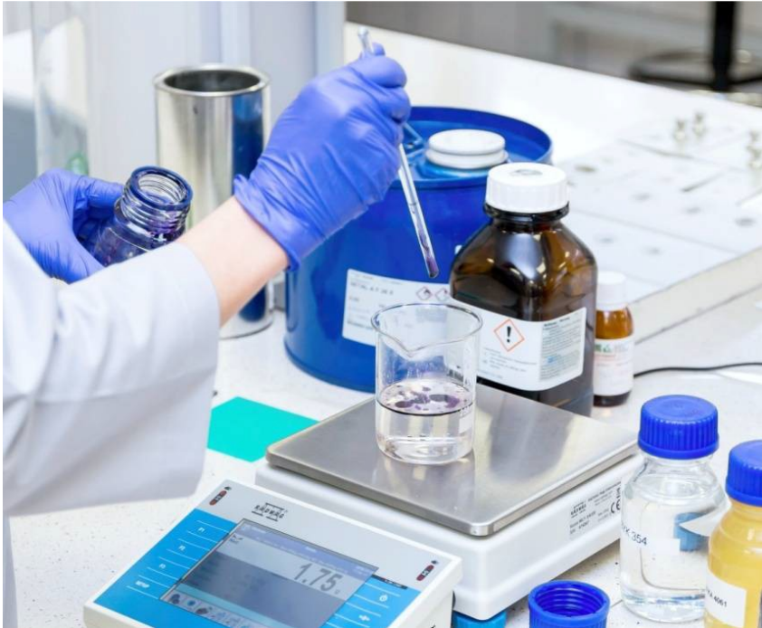
Figura 32. Dispensación de ingredientes durante la producción de pinturas.
