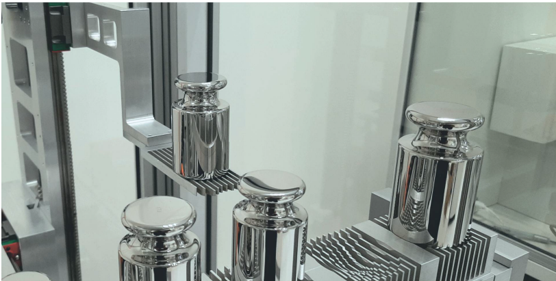
Figura 8. Comparación de patrones de masa en modo automático.
