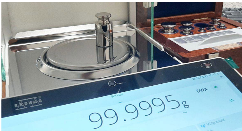
Figura 28. Prueba de centralidad de la balanza XA 220.5Y.
